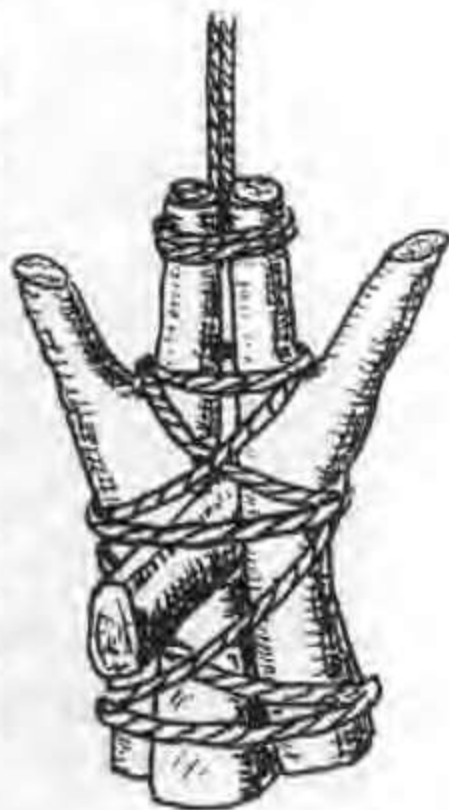
图4-17 东汉陶船木石结合碇的复原图
