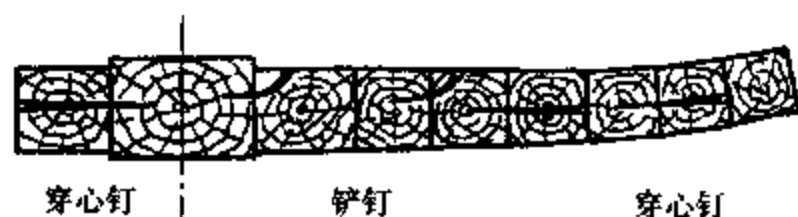
图 6-13 蓬莱古船采用的穿心钉及铲铁
