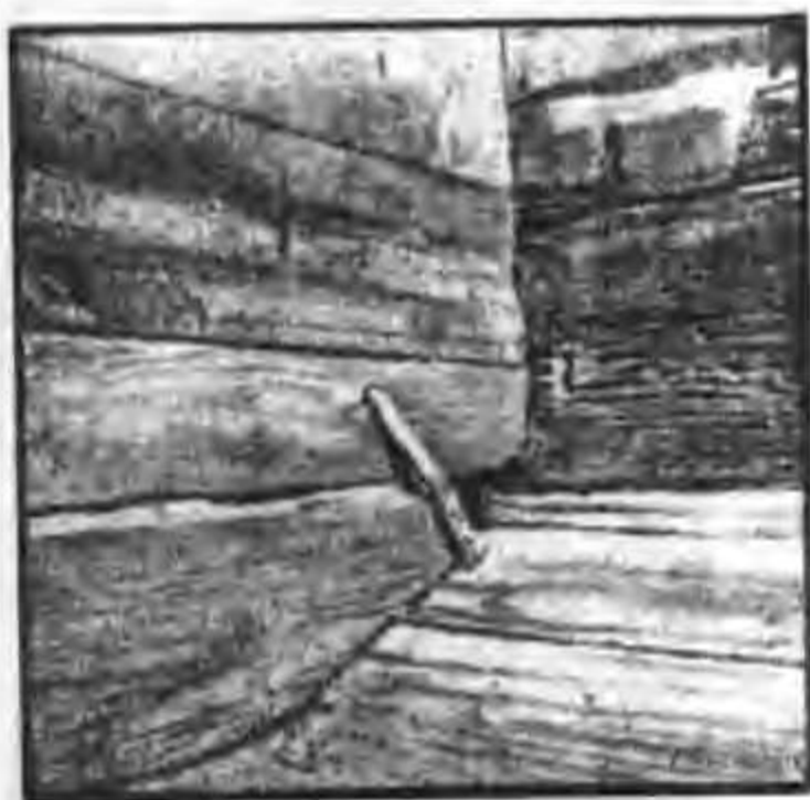
图 5-37 封浜宋船在舱壁与壳板结合处的宽背钩钉
